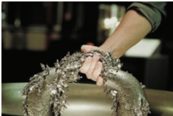
Abb. 1 In der Magnetschlange werden Eisenplättchen vorübergehend selber zu Magneten.
